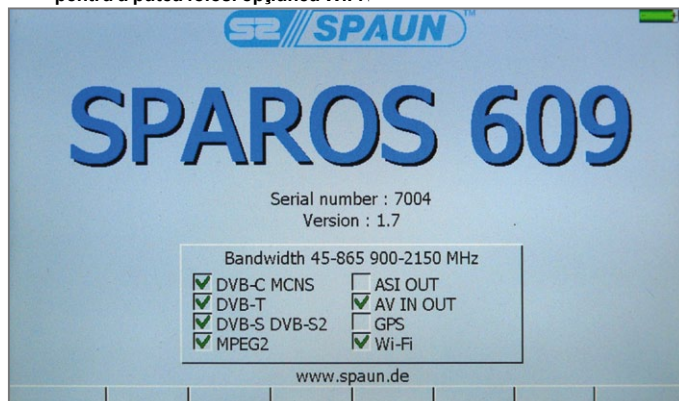
După restartarea analizorului, opțiunea WiFi este bifată ca fiind activată
