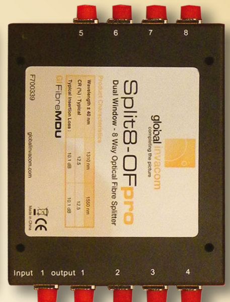
■ GlobalInvacom a modificat splitteri optici cu mufe: cablurile de conexiune optice pot fi inserate direct în splitter.
