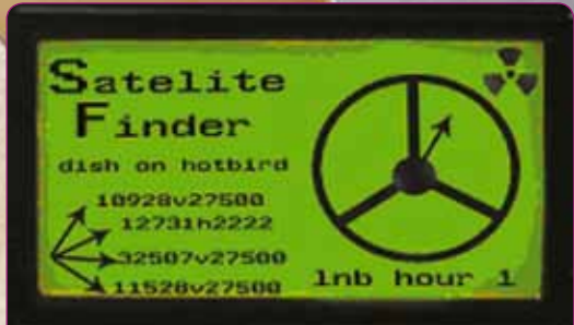
■ Afișajul Detectorului inteligent de sateliți ne arată cele mai puternice transpondere dar și modul cum trebuie roti LNB-ul
