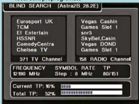
Scanarea de tipul Blind Scan poate găsi transpondere care nu sunt în lista preprogramată |
