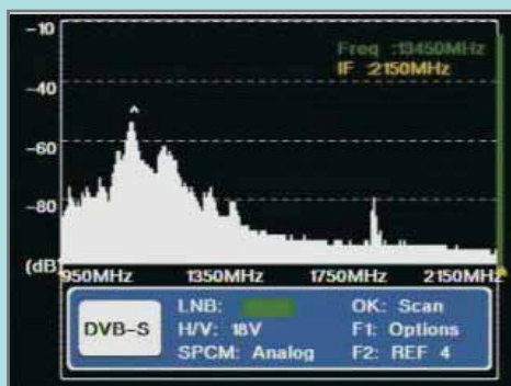
Spectru al semnalului DVB-S multi funcțional și afișat în timp real |
