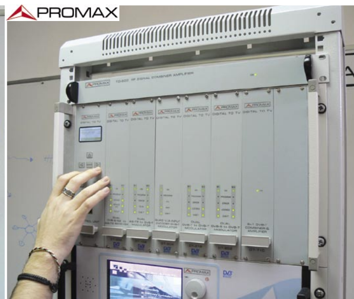
■ Teoria este demonstrată și în fapt printr-o conexiune: fiecare slot reprezintă o sursă de semnal, la celălalt capăt primești semnal combinat în standard DVB-T.
