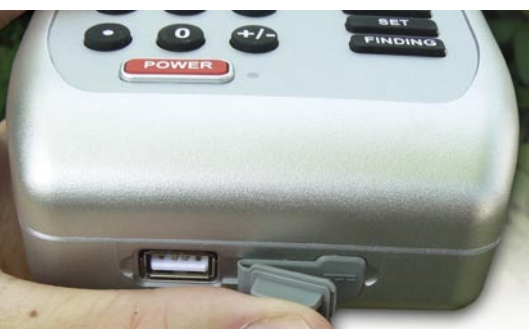
Interfața USB pentru conectarea dispozitivului la calculator, aflat alături de priză pentru alimentare
